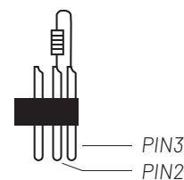
En uso profesional, la norma DMX512 requiere la presencia de un 'tapón DMX' en el último dispositivo DMX de la cadena para finalizar correctamente el bucle de señal. Este tapón está compuesto por una resistencia de 120 ohmios colocada entre el pin 2 y el pin 3 del conector XLR.
