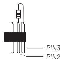
En utilisation professionnelle, la norme DMX512 impose la présence d'un «bouchon DMX» sur le dernier appareil DMX de la chaîne afin de finaliser correctement la boucle de signal. Ce bouchon est constitué d'une résistance de 120 ohms placée entre la broche 2 et la broche 3 du connecteur XLR.
